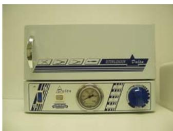
**Figura 3.11:** Forno utilizado para secar a amostra após as esferas de SiO<sub>2</sub> serem removidas.
