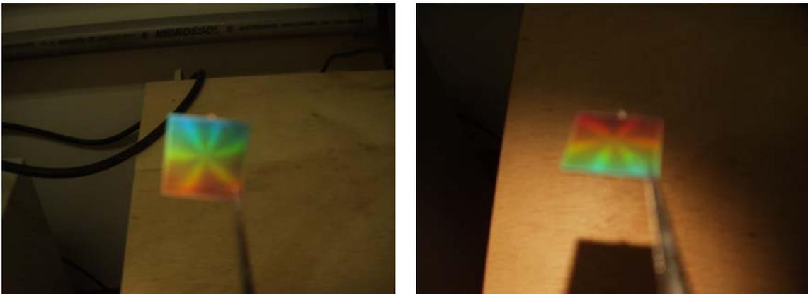
**Figura 4.19:** Máscara híbrida já fotopolimerizada. Observa-se a formação de uma estrela de seis pontas devido a um ordenamento hexagonal não-compacto (ncp) das esferas.
