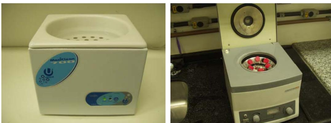
**Figura 3.2:** Fotos respectivamente do ultra-som e centrífuga utilizados primeiramente no processo de síntese das esferas de sílica e depois para a produção da solução sílica/monômero.
