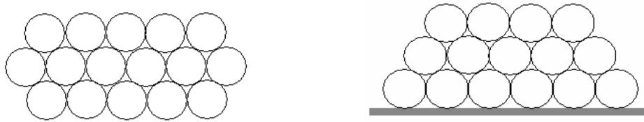
**Figura 2.10:** Ilustrações da estrutura hexagonal compacta (*hcp*) com perspectiva de cima (à esquerda) e de perfil (à direita).
