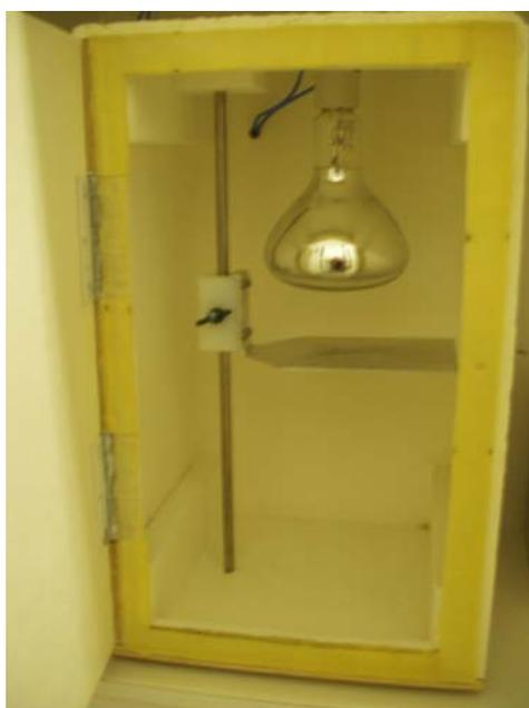
**Figura 3.8:** Foto do forno de radiação ultravioleta construído no laboratório e utilizado para polimerizar a amostra.
