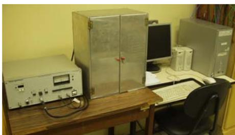
**Figura 3.14:** Potenciostato e caixa metálica onde se encontra a célula eletroquímica utilizada nos processos de voltametria e deposição.
