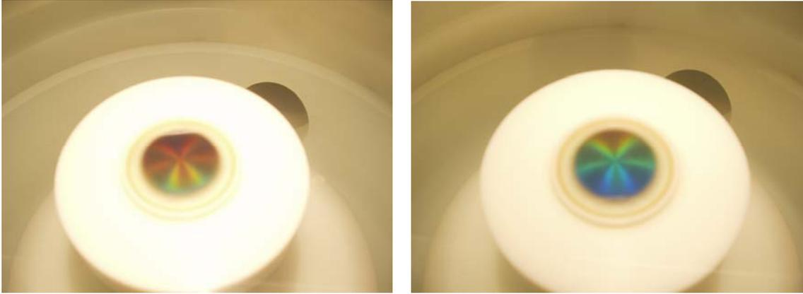
**Figura 4.18:** Amostras em rotação sobre o *spin-coater*. Após o auto-ordenamento e aparição da estrela a mesma permanece estacionária durante o processo.
