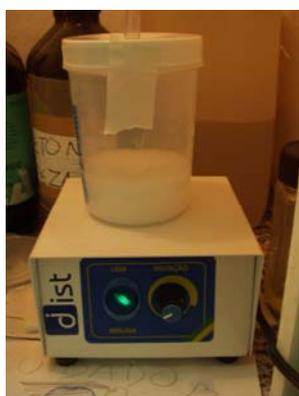
**Figura 3.1:** Foto do agitador magnético utilizado na síntese das esferas de  $\text{SiO}_2$ .
