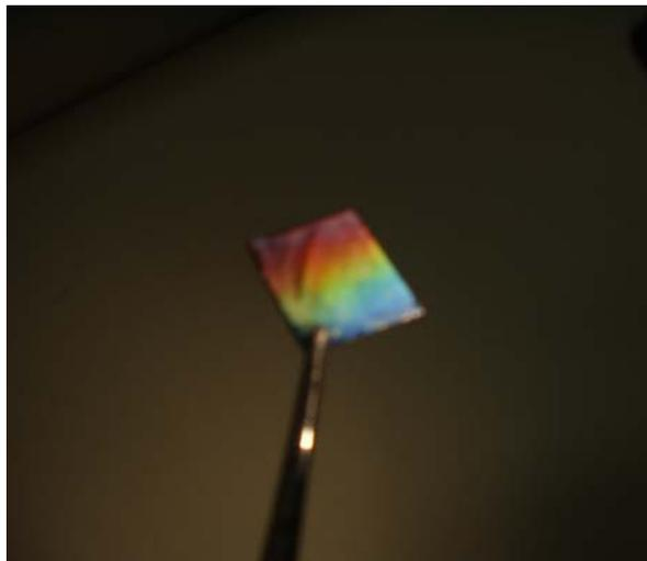
**Figura 4.17:** Substrato de silício com a solução sílica/monômero uniformemente espalhada por sua superfície. Pode-se observar que a solução antes do auto-ordenamento possui um aspecto iridescente.
