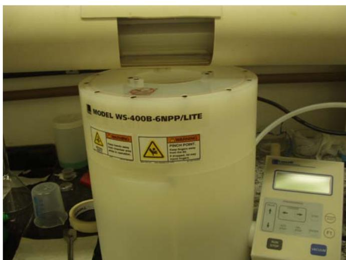
**Figura 3.9:** Foto do forno de radiação ultravioleta construído no laboratório e adaptado sobre o *spin-coater*.
