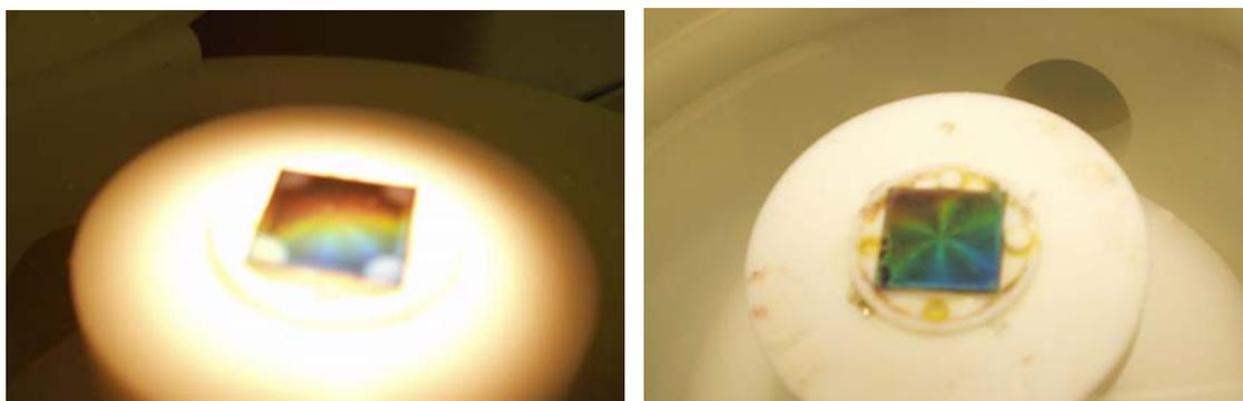
**Figura 4.26:** A imagem do lado esquerdo mostra os efeitos de borda existentes na produção de filmes mais espessos onde há excesso de solução. Após o término do processo de *spin-coating* a solução excedente no substrato desorganiza as esferas que haviam atingido o ordenamento. A imagem do lado direito representa uma amostra feita com os mesmos parâmetros, entretanto, polimerizada ainda no *spin-coater*.
