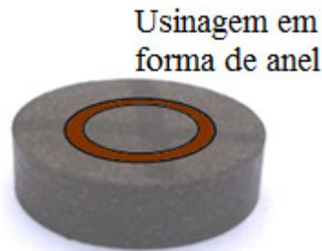
*Figura 105 -  $Nd_2Fe_{14}B$  compactado em forma de disco e posterior usinagem em forma de anel.*
