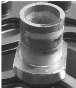
Figura 27 - Anéis fabricados através do método de extrusão reversa.
