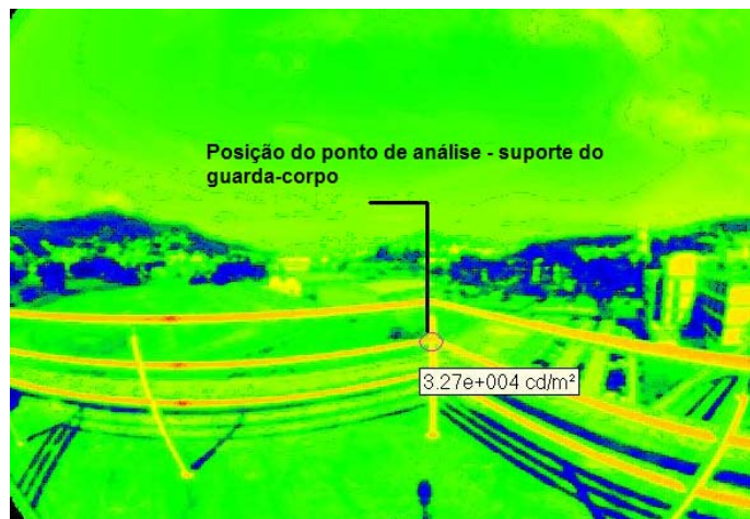
Figura A10 - Imagem fotométrica para avaliação dos valores de luminâncias (ponto no telhado).
