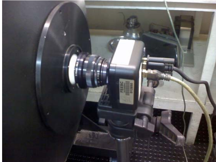
Figura A3 – A IQCam adaptada ao detector de fluxo da esfera integradora.
