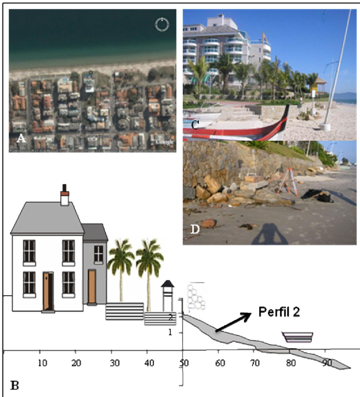
Figura 34. (A) Imagem *Google Earth* com localização do perfil 2 ( $27^{\circ}25'38.54''S$  -  $48^{\circ}27'32.79''W$ ); (B) perfil esquemático da orla (em metros), cobrindo os máximos erosivo e acrescivo da praia; (C) vista de prédios próximos ao mar, porção central da Praia de Canasvieiras e (D) muros de contenção à erosão presentes nesse setor da praia.
