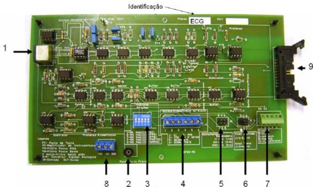
**Figura 3.4 – Módulo de ECG, EMG, EOG. 1-Conector para o cabo dos eletrodos, 2-Conector para a ponteira de prova, 3-Chave habilita circuitos, 4-Saídas dos circuitos disponíveis para o aluno, 5-Jumper para a seleção do ganho da ponteira de prova, 6-Jumper para seleção sinal teste/sinal dos eletrodos, 7-Conector para entrada de sinal de circuito externo, 8-Conector para alimentação de circuito externo e 9-Conector para ligação com o módulo base (Reproduzido de Rathke, 2008).**
