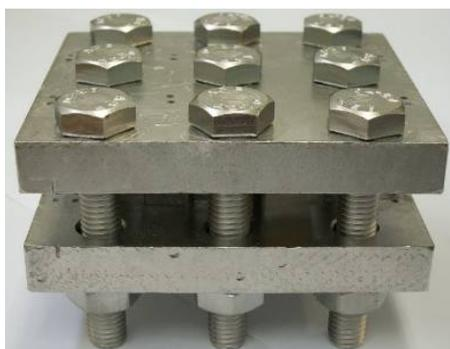
Figura 4-8: Matriz utilizada para realizar os testes de interação estática.
