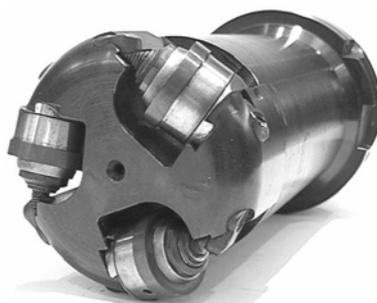
Figura 3-12: Barra de mandrilar com insertos rotativos (SAHM; ABELE; SCHULZ, 2002).
