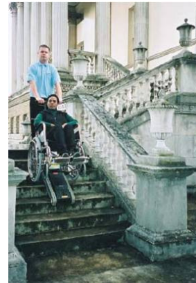
Figura 69 – Equipamento eletromecânico inserido na escada principal de acesso à edificação. Disponível em: EH_EasyAccess_2004.pdf . Acesso: 08/06/2009
