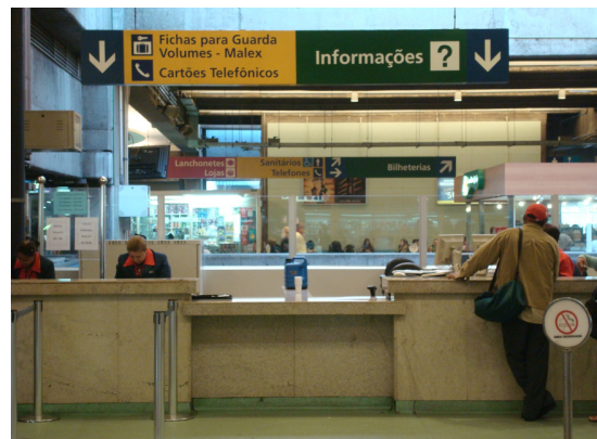
Figura 81 – Balcão com diferentes alturas e espaço para aproximação de pessoas em cadeira de rodas e crianças. Terminal Rodoviário, São Paulo – SP.
