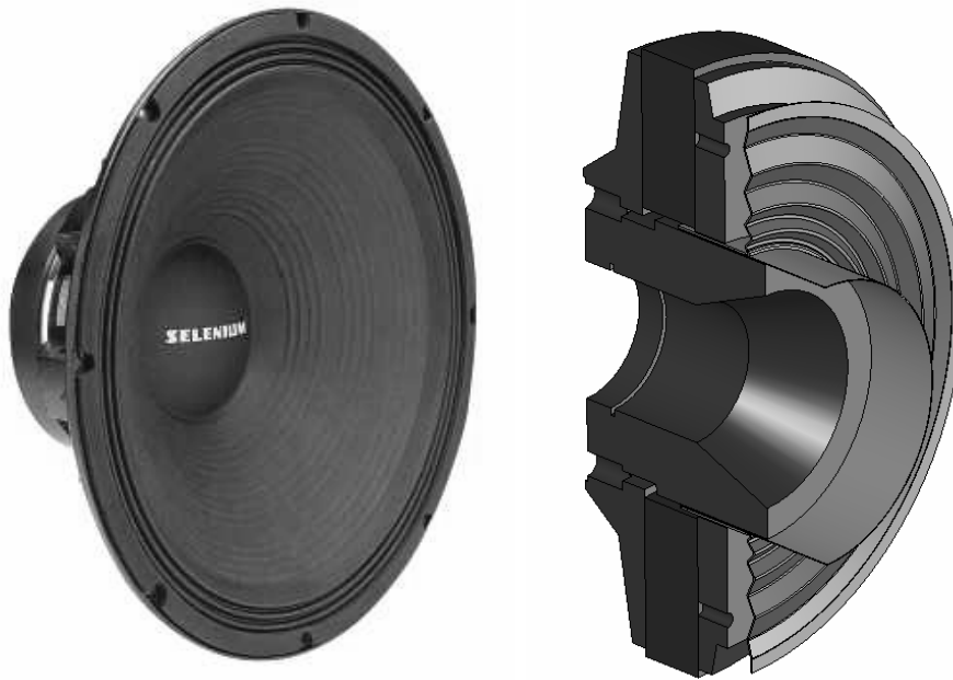
Figura 3.1: Apenas o magneto, a bobina e a suspensão da bobina foram aproveitados desse alto-falante para se construir o atuador para o termoacústico.
