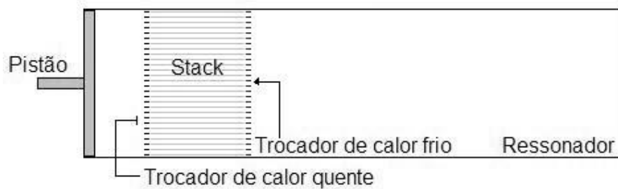
Figura 2.4: Refrigerador termoacústico tipo onda estacionária.
