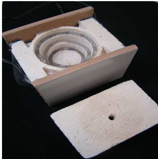
Figura 4-5 - Forno projetado e fabricado no Núcleo de Materiais Cerâmicos e Vidros (CERMAT) do Departamento de Engenharia Mecânica/UFSC.
