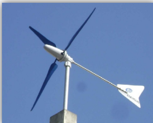
Figura 5.4 – Turbina eólica modelo GERAR 246 produzida por [19] e utilizada no projeto.
