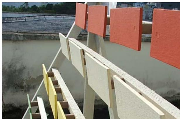
Figura 7: Disposição das placas no cavalete
