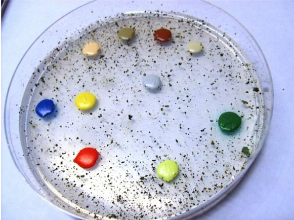
Figura 48: Placa de Petri com tinta - início da exposição.
