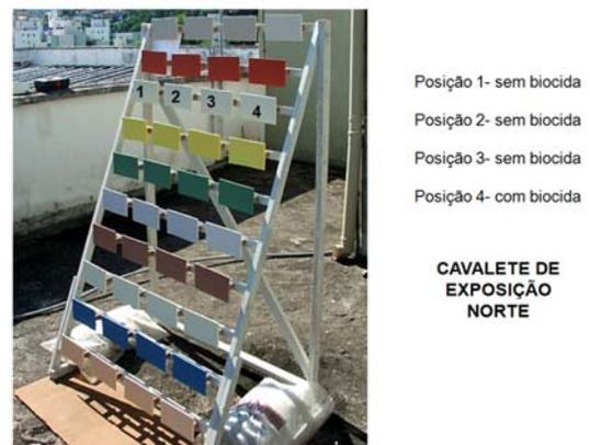
Figura 10: Posicionamento das amostras com e sem biocida
