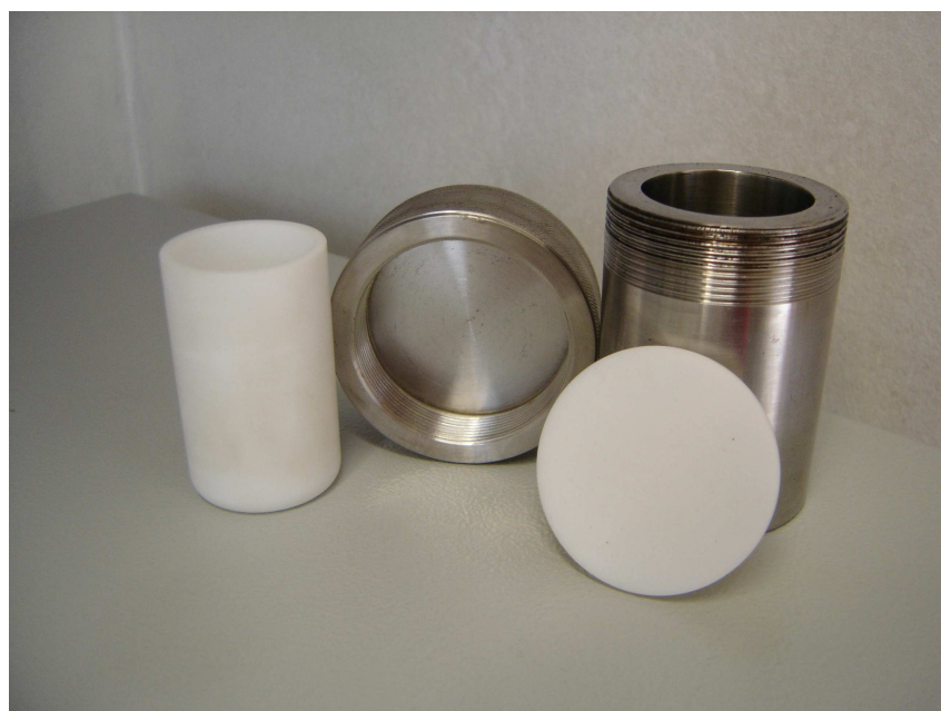
Figura 3.2: Autoclave, o copo e a tampa de teflon, com volume de 40 ml.
