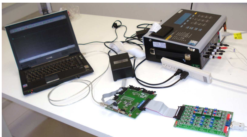
Figura 5.14 – Foto do ensaio de segurança elétrica realizado no LAT-IEB-UFSC. Durante o ensaio foi registrado uma temperatura de 21°C e umidade relativa de 71%.
