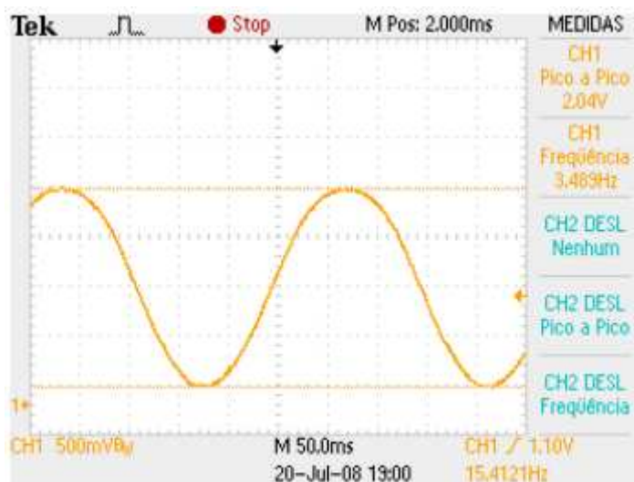
Figura 5.3 – Registro simulado utilizando gerador de funções configurado para gerar, na entrada do canal de EEG, uma senóide de 400\mu\text{Vpp} e 3,5Hz. Gráfico com escala X = 50\text{ms/DV} ; Y = 500\text{mV/DV} .
