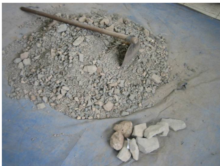
Figura 6.1 – Ensaio de densidade máxima, material sendo homogeneizado
