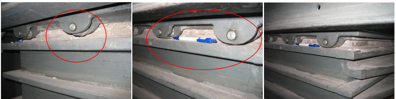
Figura 7.14 – Ensaio 3 – Comportamento observado ao longo do ensaio: caixa superior deixa de ficar apoiada no interior devido ao comportamento dilatante do material
