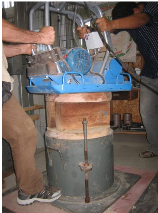
Figura 6.3 – Ensaio de densidade máxima, onde pode ser observado o cilindro, o aparato de madeira de apoio da placa vibratória e a placa vibratória PV 2000
