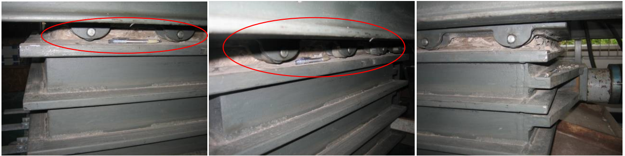
Figura 7.11 – Ensaio 2 – Comportamento observado ao longo do ensaio: caixa superior deixa de ficar apoiada no interior devido ao comportamento dilatante do material
