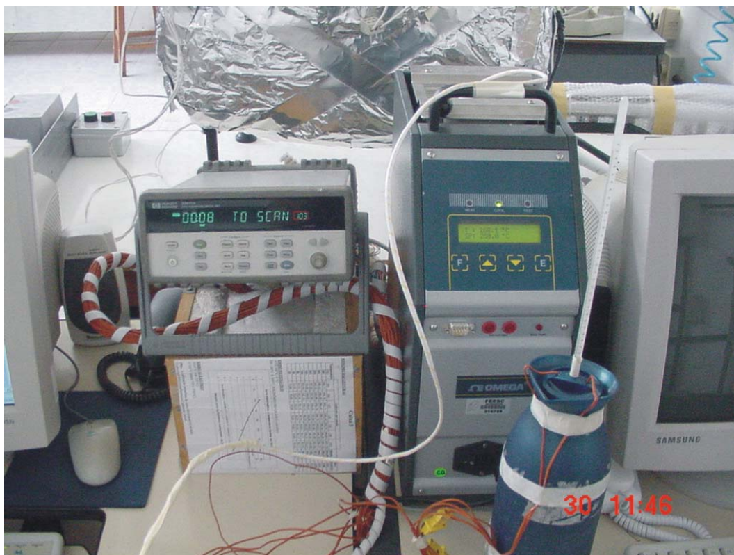
Figura 4-5 – Montagem da calibração do sistema de medição no forno OMEGA CL552.
