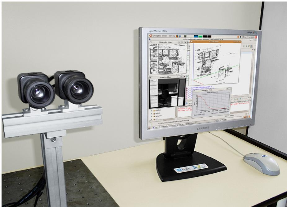
**Figura 16:** Sistema binocular de aquisição de imagens
