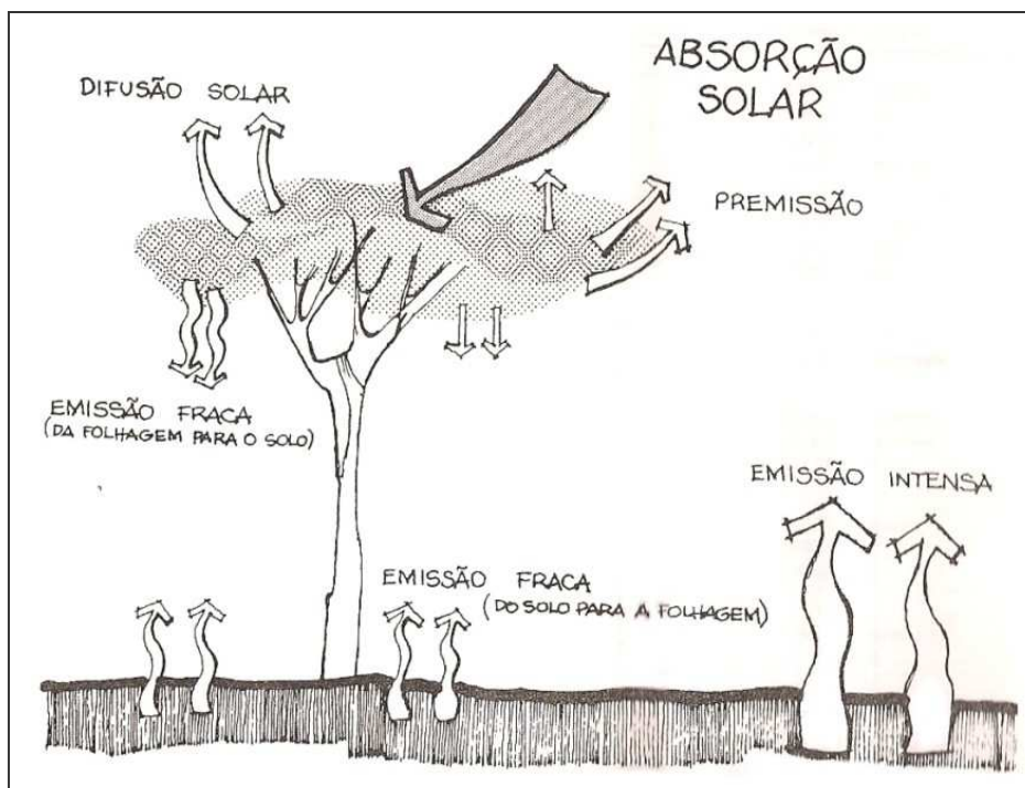
Figura 12 – Efeito da vegetação nas transformações da radiação. Fonte: ROMERO, 2000, p.33.
