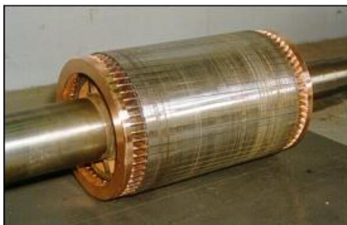
**Figura 4.2-Rotor de gaiola com barra de cobre.**
