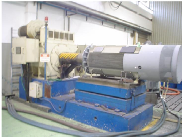
**Figura 3.1-Motor acoplado num dinamômetro de 600kW.**
