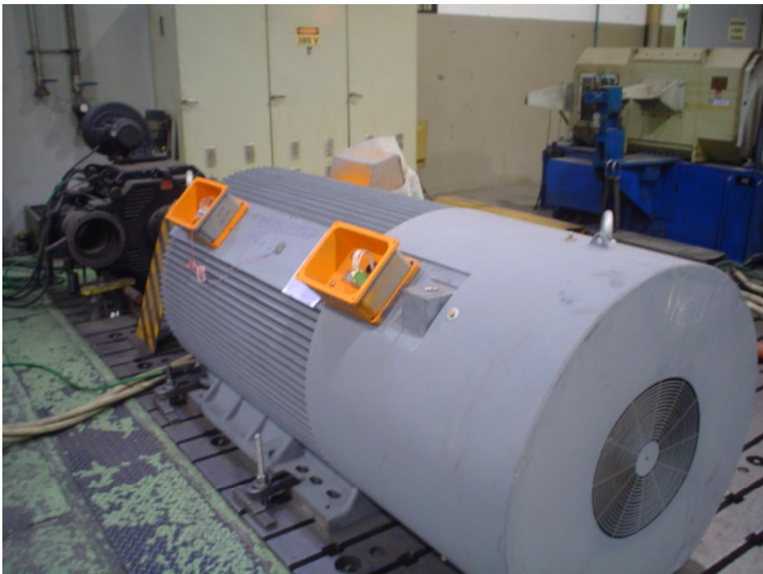
**Figura 7.4-Motor rotor de gaiola em “*forward short circuit*”.**
