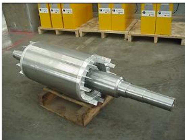
**Figura 4.3-Rotor de gaiola com alumínio injetado.**
