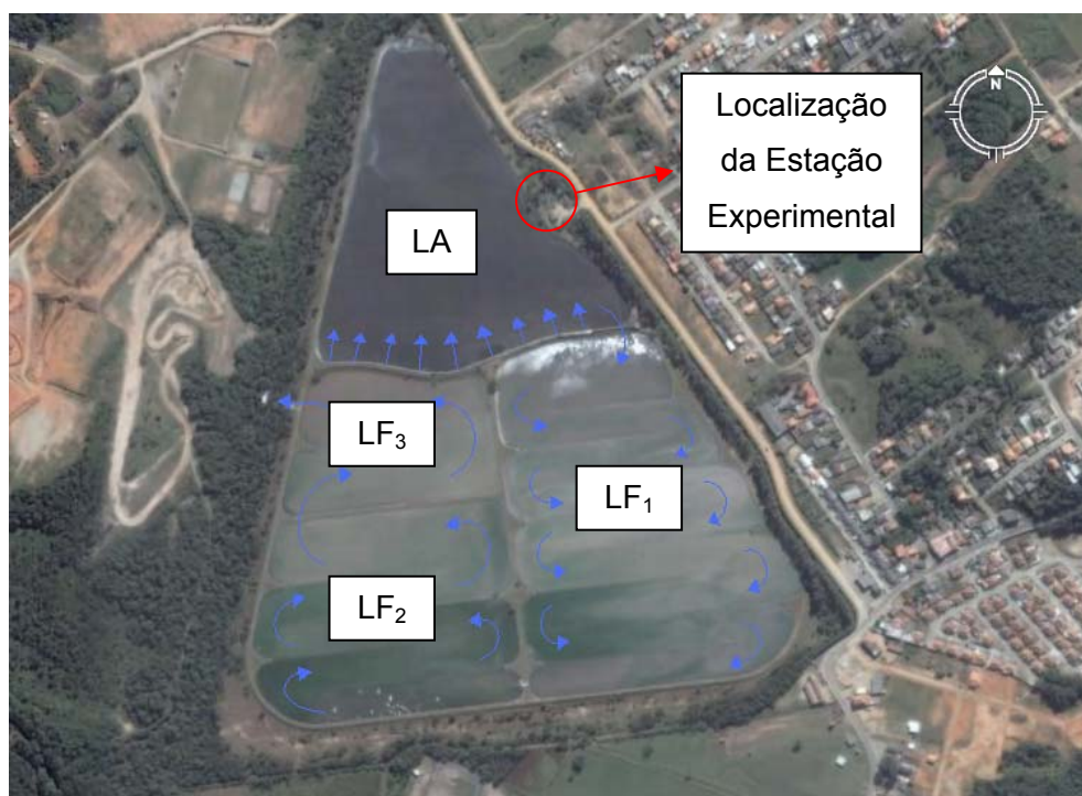
Figura 7: Estação de Tratamento de Esgoto Continental da Casan com detalhe para a localização da Estação Experimental. (LA: Lagoa Anaeróbia; LF 1 : Lagoa Facultativa 1; LF 2 : Lagoa Facultativa 2; LF 3 : Lagoa Facultativa 3).
