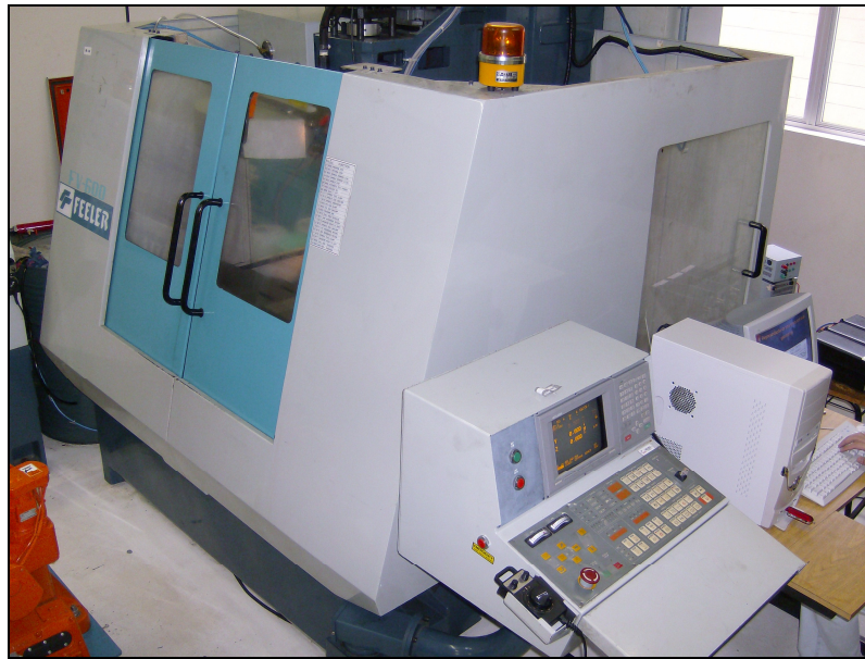
Figura 3.7 - Centro de usinagem Feeler utilizado no experimento
