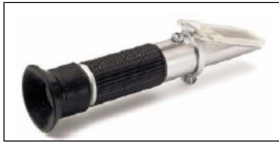
Figura 2.22 – Refratômetro utilizado para manutenção da concentração do fluido (Gomes, 2005).
