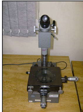
Figura 4.3 – Microscópio utilizado para avaliação do desgaste das brocas
