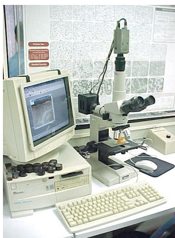
Figura 3.2 – Microscópio utilizado para avaliação dos corpos-de-prova
