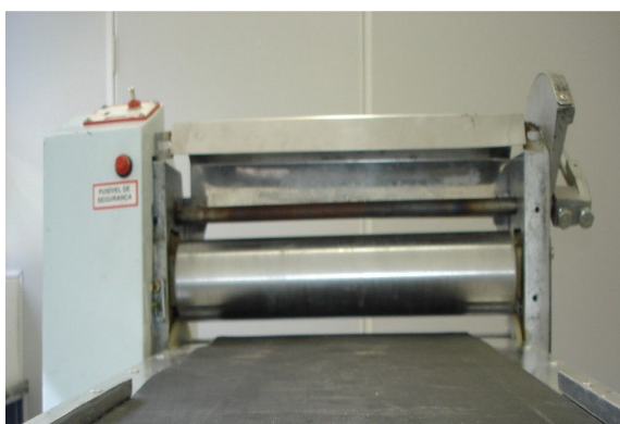
Figura 11 – Protótipo do laminador laboratorial, vista frontal.
