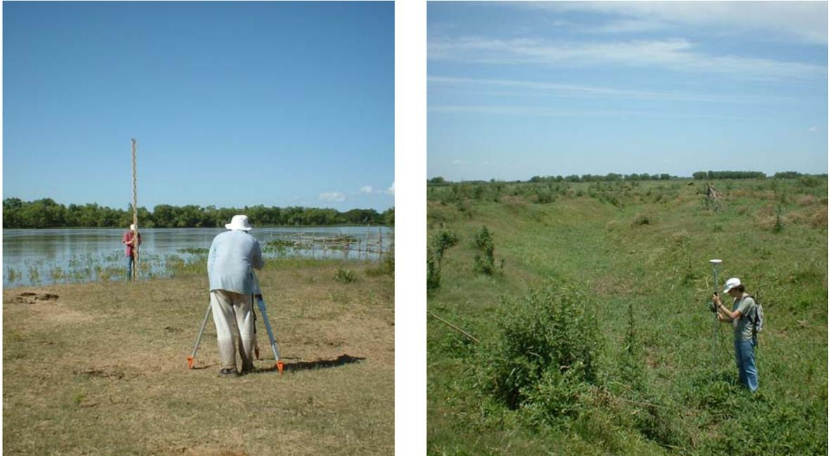
**FIGURA 13:** Execução de perfis topográficos.
