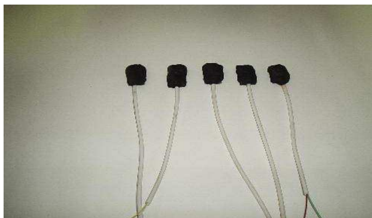
Figura 5.31 – Compensadores de temperatura para aço e PRFC
