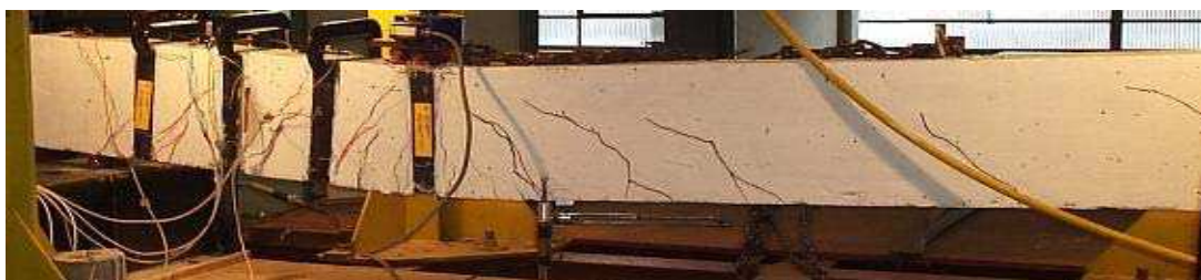
Figura 6.15 – Viga 21 após o ensaio
