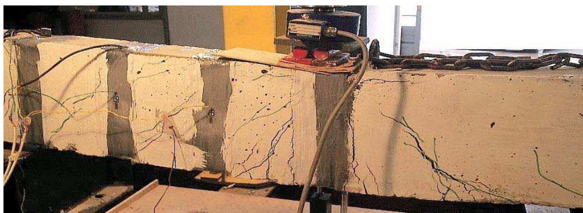
Figura 6.17 – Viga 28 após o ensaio .
