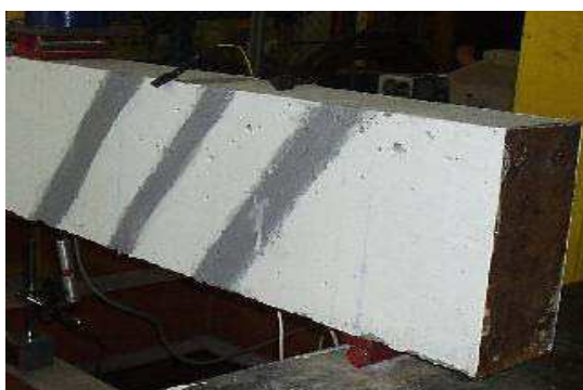
Figura 5.20- Sistema de reforço embutido no sentido da largura da lâmina
