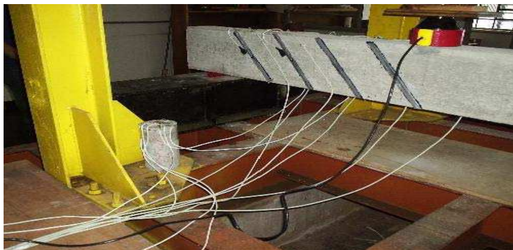
Figura 5.33 – Utilização de compensadores de temperatura em ensaio
