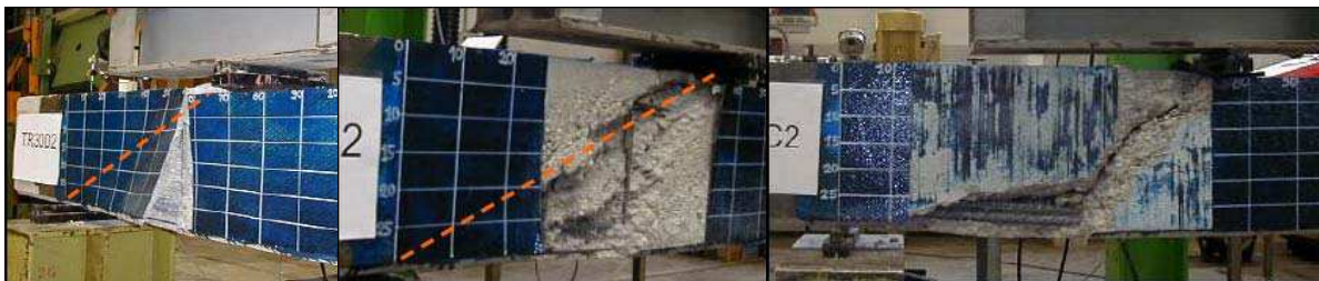
Figura 3.39 – Modos de ruptura das vigas ensaiadas (PELLEGRINO E MODENA, 2002).
