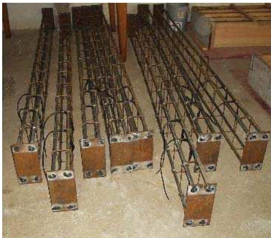
Figura 5.11 – Detalhe das armaduras
