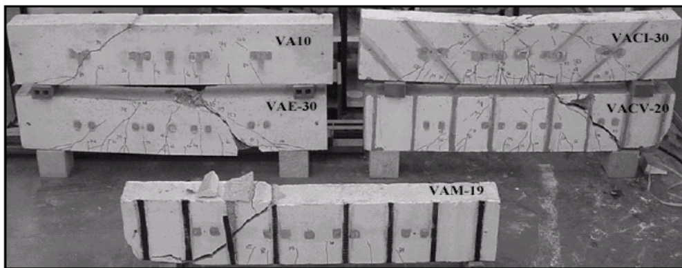
Figura 3.21 – Modos de ruptura verificados na série A (DIAS E BARROS, 2003).
