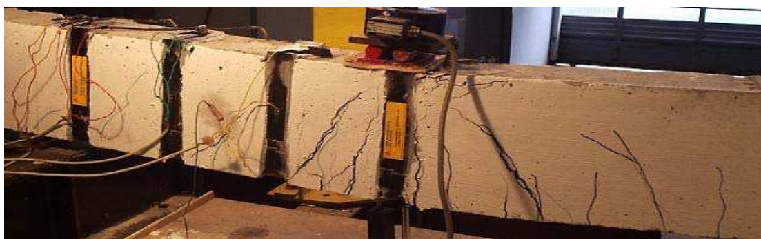
Figura 6.16 – Viga 31 após o ensaio
