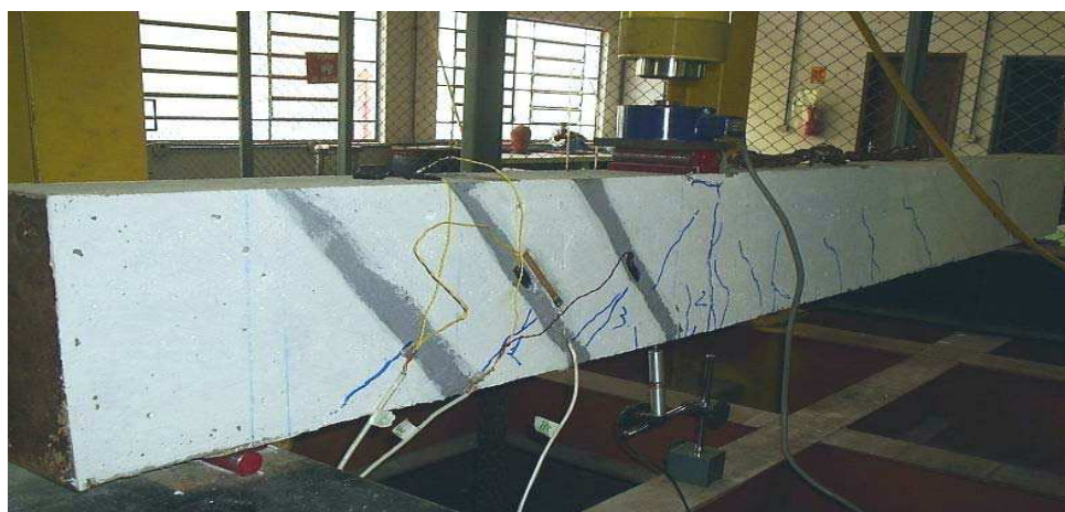
Figura 6.5 – Viga 11 após o ensaio.
