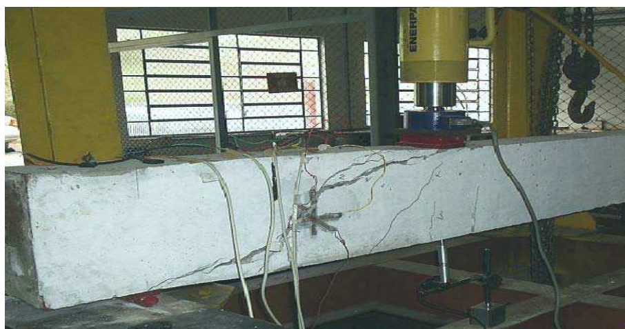
Figura 6.1 – Ruptura da Viga Referência (frente).
