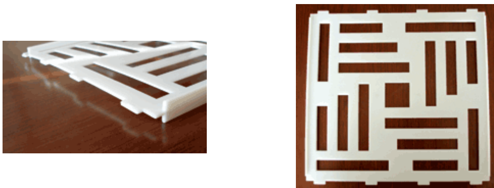
Figura 8.45 – Empenamento da peça após a moldagem por injeção.
