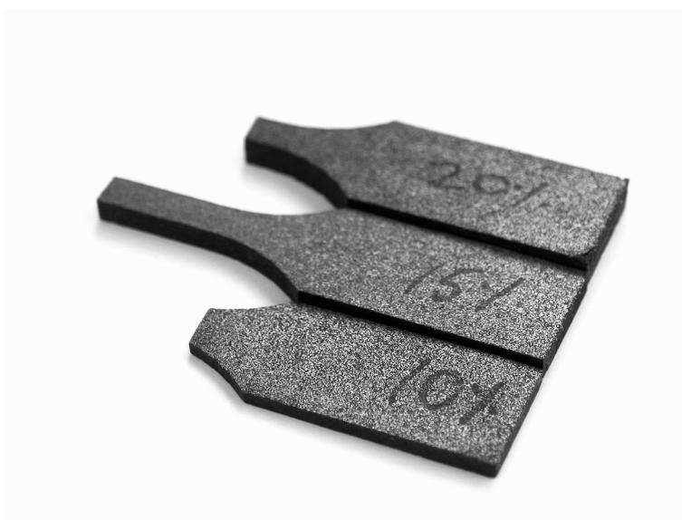
Figura 75: Espessura da camada sedimentada após a remoção da camada de resina nos corpos de prova em função da fração volumétrica de fibras.
