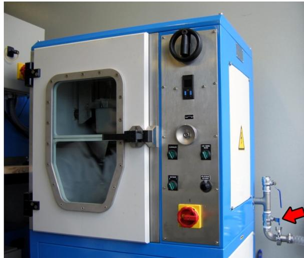
Figura 36: Indicação da comunicação com a câmara de vácuo por válvula na máquina de vazamento MJI CV 96.
