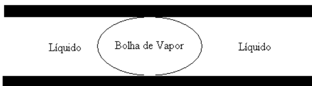
Figura 2.6 - Crescimento confinado de uma bolha.
