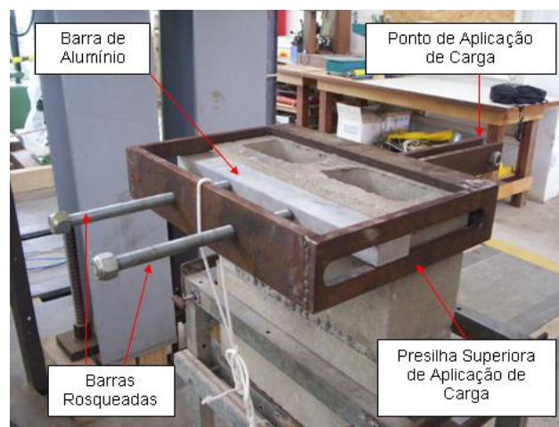
Figura 2.23 – Aparato utilizado por Fernandes, et al (2006) na aplicação de esforços de flexo-compressão em prismas de alvenaria de acordo com ASTM 1072C
