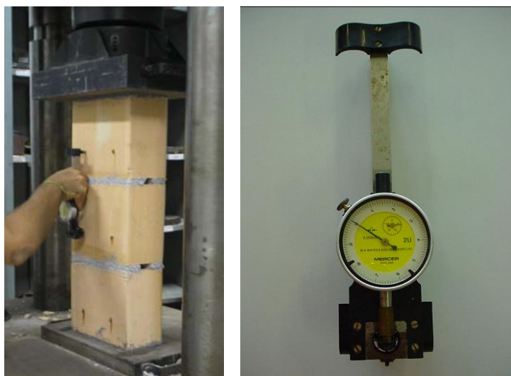
Figura 3.11 – Medição de deformação sendo feita em um prisma durante o ensaio de compressão e detalhe do extensômetro utilizado
