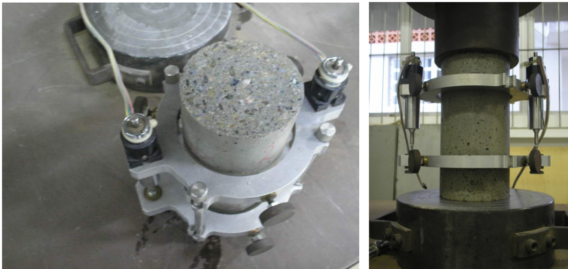
Figura 3.9 – Posicionamento dos extensômetros no ensaio de módulo de elasticidade dos grautes
