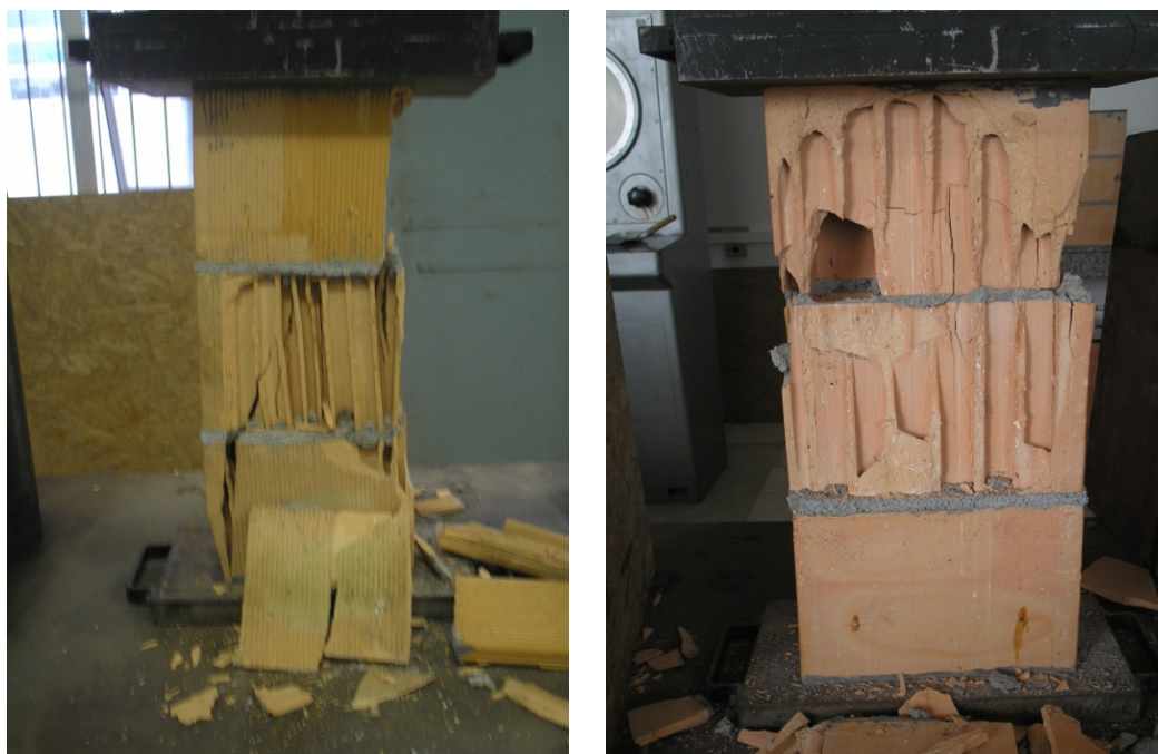
Figura 4.10 – Modo de ruptura explosiva, verificada em prismas com argamassa A2 e A3, com maior frequência em prismas com argamassa A3
