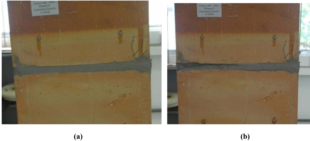
Figura 4.8 – Modo de ruptura mais freqüente em prismas com argamassa A1: a) Junta íntegra durante o carregamento e b) ruptura da junta com aproximação da carga máxima
