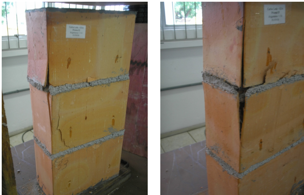
Figura 4.9 – Modo de ruptura por fendilhamento dos blocos nos prismas com argamassa A2 e A3, com maior freqüência em prismas com argamassa A2
