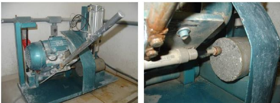
Figura 3.8 – Método de regularização superficial dos corpos-de-prova de graute
