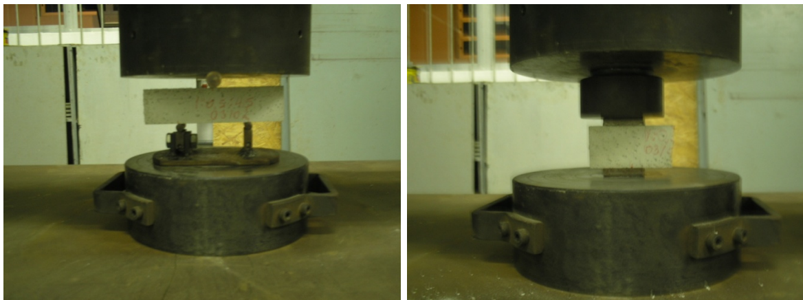
Figura 3.6 – Ensaio de resistência à tração na flexão e resistência à compressão de acordo com a NBR 13279 (2005)
