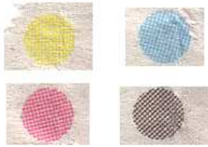
Figura 8.1: Exemplo de um padrão de teste para halftoning , ilustrando os colorantes C, M, Y e K.
