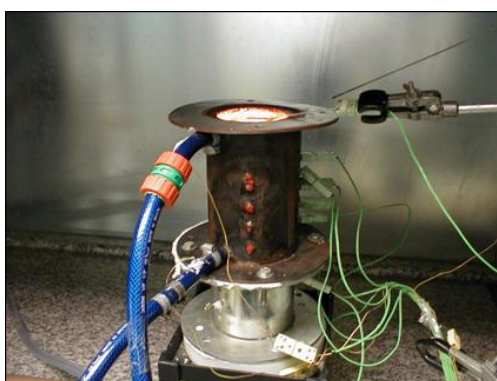
Figura 3.4. Queimador poroso integrado com um trocador de calor utilizado nos experimentos.
