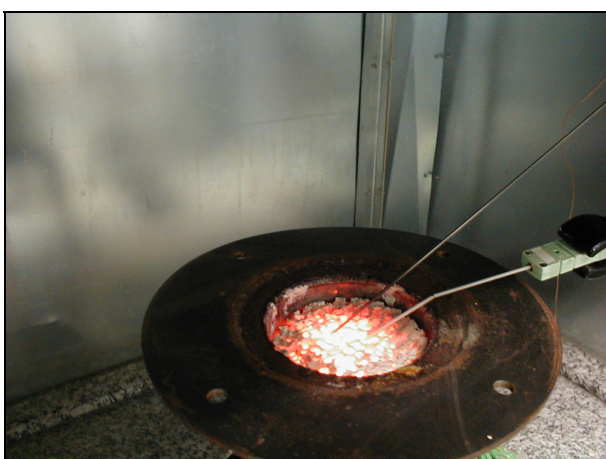
Vista superior do queimador, com a frente de chama posicionada próxima a região central.
