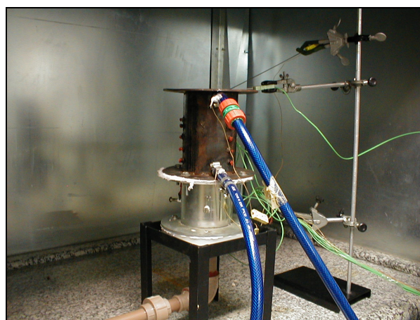
Queimador poroso com trocador de calor integrado.
