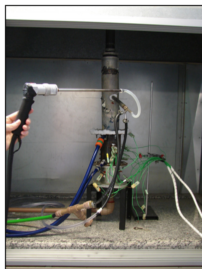
Chaminé adaptada na superfície do queimador para medição da composição dos gases de exaustão.
