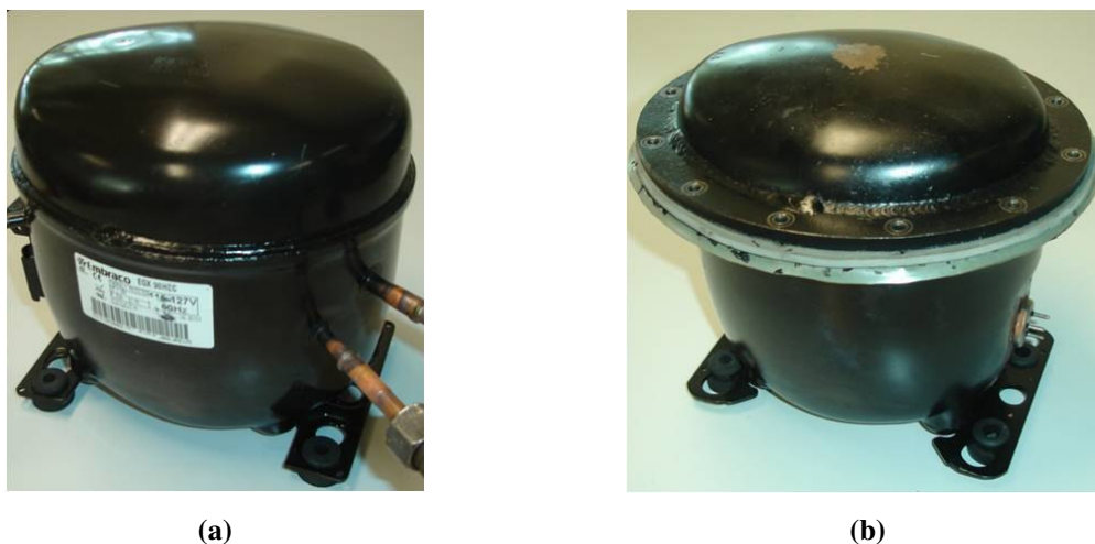
Figura 5.13 – Carcaça do compressor EGX90HLC (a) comercializado e (b) protótipo.
