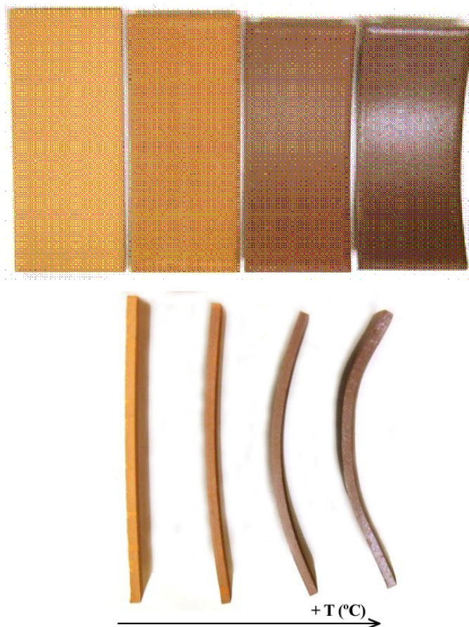
Figura 19 – Corpos de Prova de massa B, após ensaio de piroplasticidade. Vista frontal e lateral. Temperaturas de queima: 1000, 1050, 1100 e 1150 °C.
