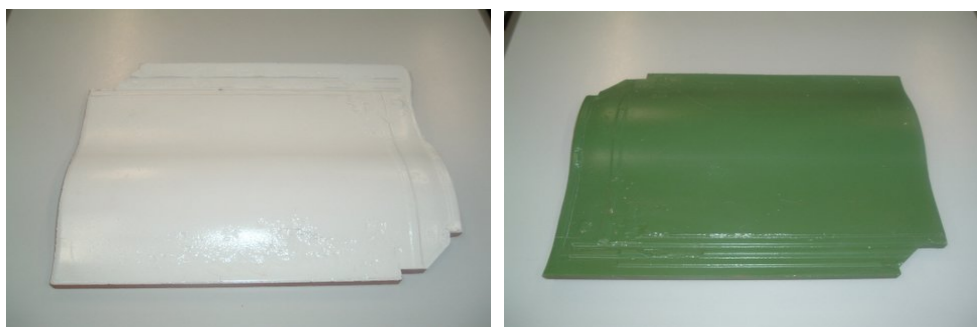
Figura 25 – Testes de aplicação de esmalte em telhas
