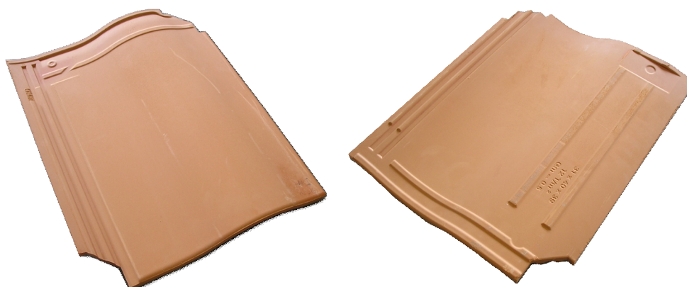
Figura 23 – Vistas superior e inferior da telha fabricada com a massa B após a queima.
