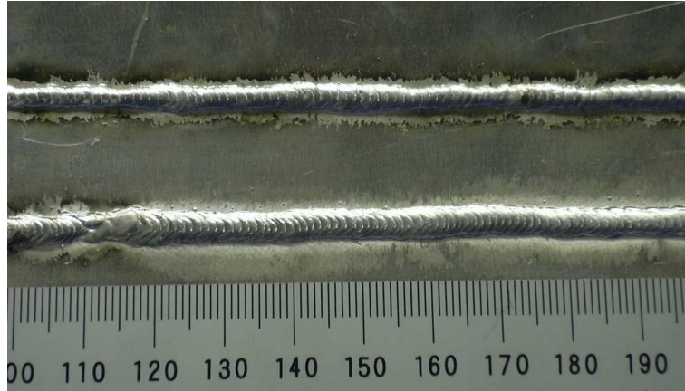
Figura 3.6 - Cordões depositados – Alumínio, chapa de 0,8 mm de espessura
