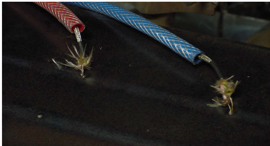
Figura 4.20 - Termopares instalados no verso da chapa
