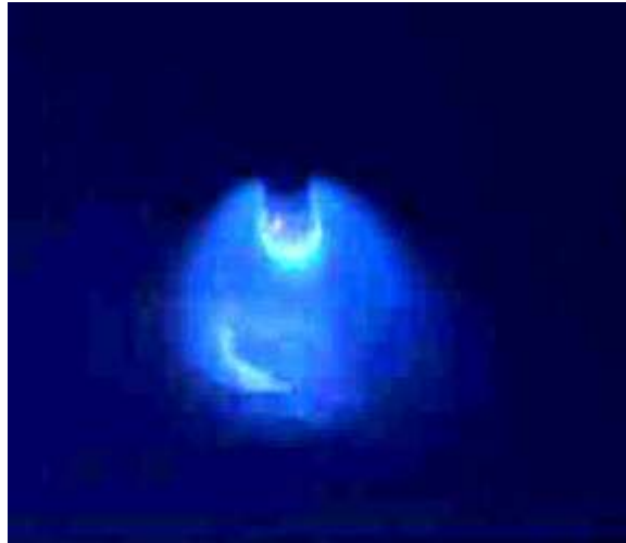
Figura 5.36 - Arco MIG CA na polaridade negativa (70%EN e In=60 A)
