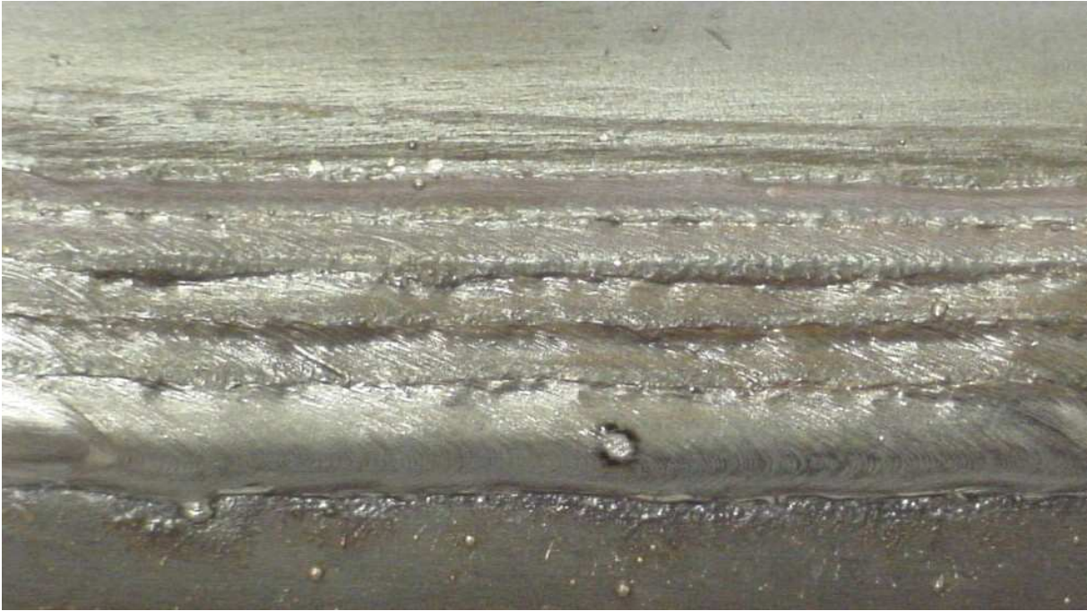
Figura 6.8 - Depósito de revestimento sobre tubo
