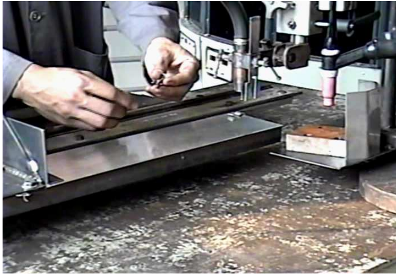
Figura 4.8 – Conjunto para ensaios com referencia visual de comprimento de arco
