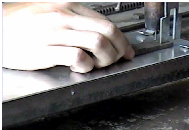
Figura 4.9 - Dispositivo para referenciar visualmente o comprimento do arco.
