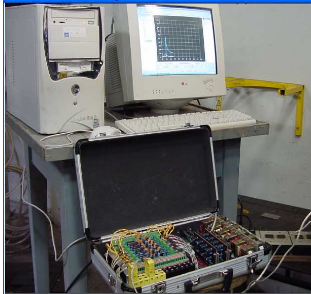
Figura 4.21 - Sistema de monitoração de temperatura
