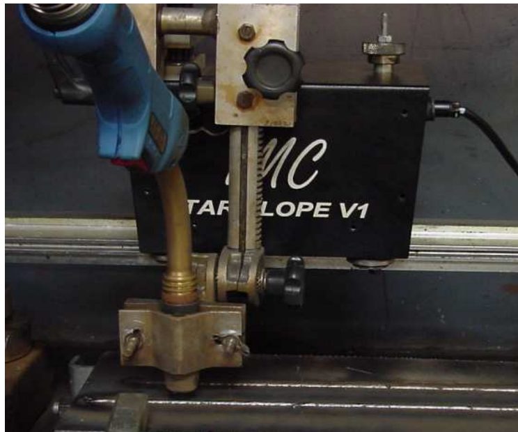
Figura 4.17 - Sistema de deslocamento de tocha (Tartílope)
