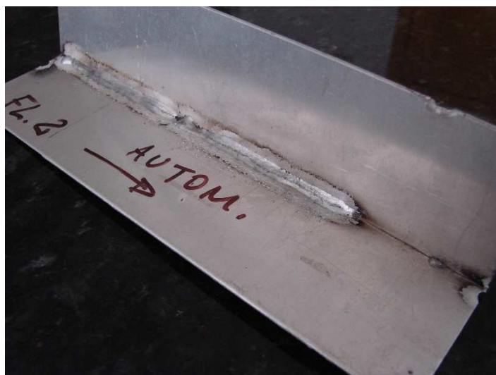
Figura 3.8 - Junta de filete MIG CA – Alumínio, chapa de 1 mm de espessura
