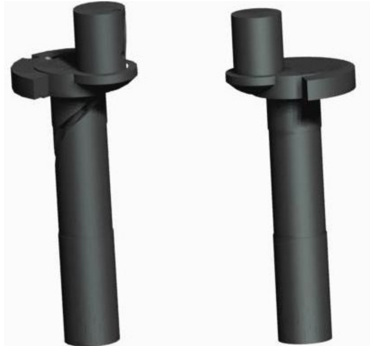
Figura 3.4 - Eixo com as ranhuras (à esquerda). Eixo sem as ranhuras (à direita).
