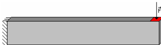
Figura 5.1 - Barra engastada sob a ação de uma força em um conjunto de nós.
