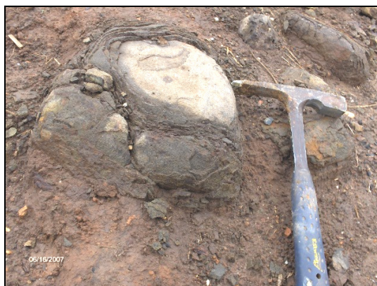
Figuras 57 e 58: Topo de derrame da Formação Serra Geral. Basalto bastante fraturado sofrendo esfoliação esferoidal.
