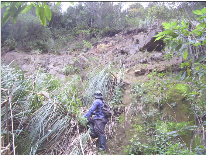
Figura 26: Reativação da cicatriz de deslizamento. Foto tirada dentro da cicatriz, nota-se a inclinação da encosta e os blocos acima prestes a cair.
