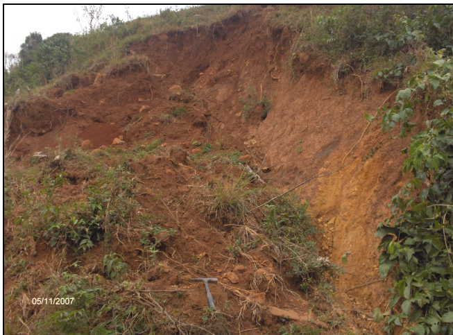
Figura 23 e 24: Deslizamento rotacional em dois setores da mesma encosta. Sendo um no depósito cortado pelo rio de pequeno porte (2 m de profundidade aproximadamente) e outro na margem. Foto: Solange F. Vieira (Junho de 2007)
