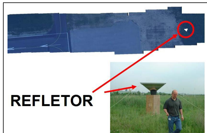
Fig. 86 – Refletor para pré-sinalização de aerolevanteamento
