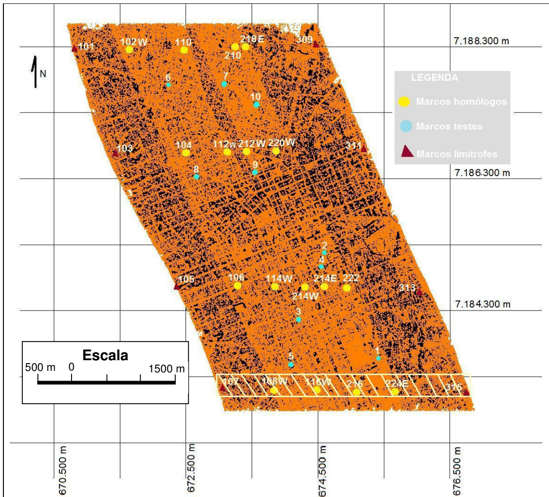
Figura 70 – Arranjo espacial dos marcos no trecho inferior do bloco destinados ao ajustamento do bloco
