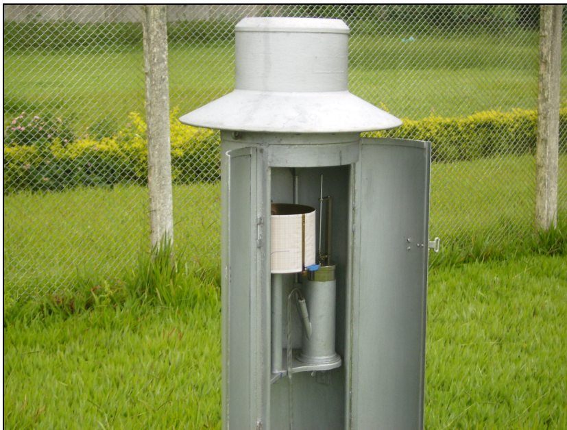
Figura 17 – Pluviógrafo, registrando dados de intensidade da precipitação. 05/01/2007.
