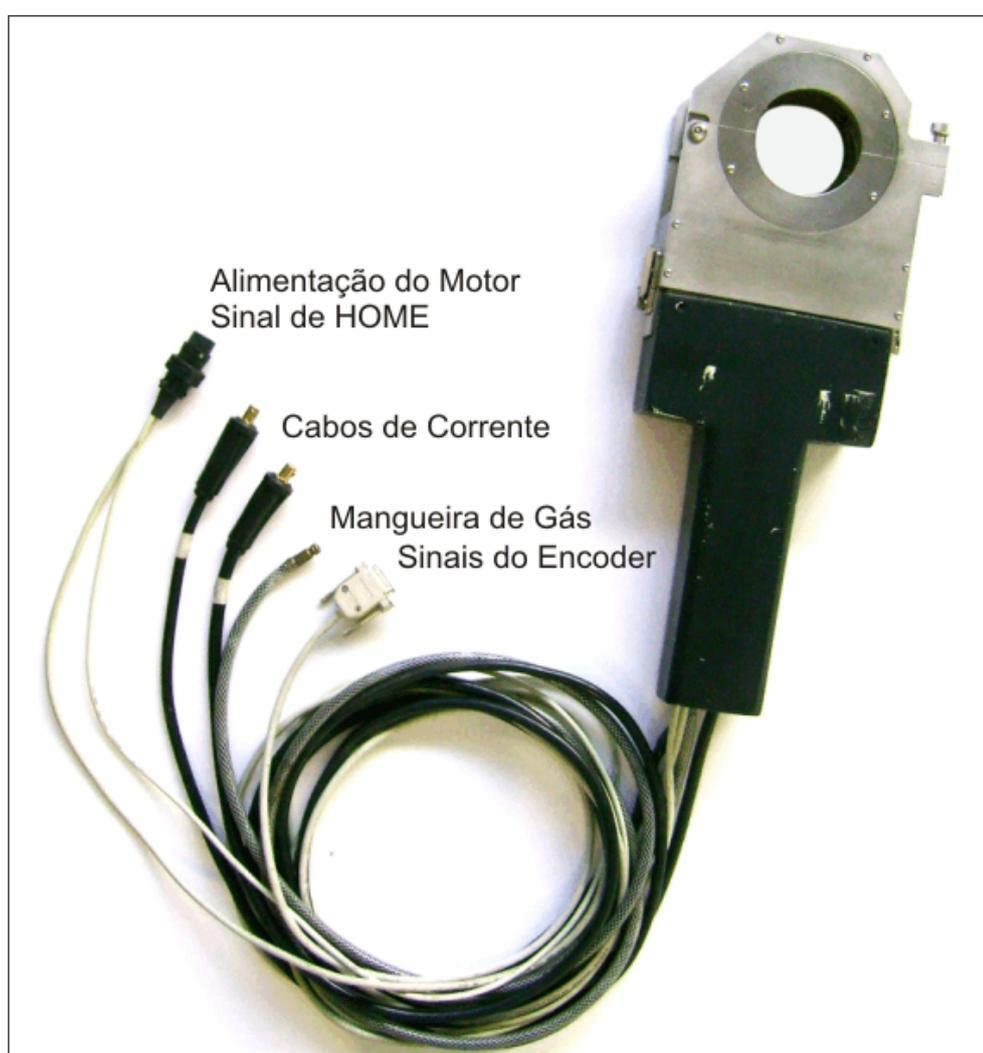
Figura 4.5 – Cabeçote orbital com o mangote instalado
