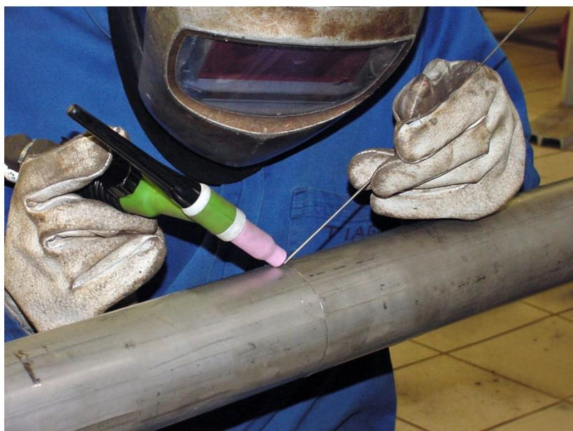
Figura 1.1 - Soldagem manual de um tubo estático
