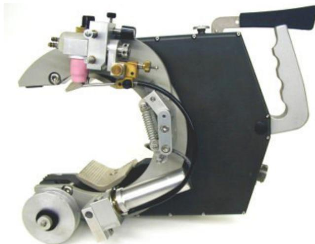
Figura 2.9 – Cabeçote orbital de câmara aberta (19)
