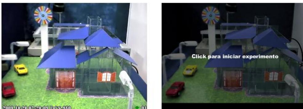
Função: Estudo das transformações energéticas, verificação da conversão da energia solar em energia elétrica e energia mecânica, efeito fotovoltaico, semicondutores e verificação da seletividades do funcionamento quanto a região do espectro da irradiação incidente.
