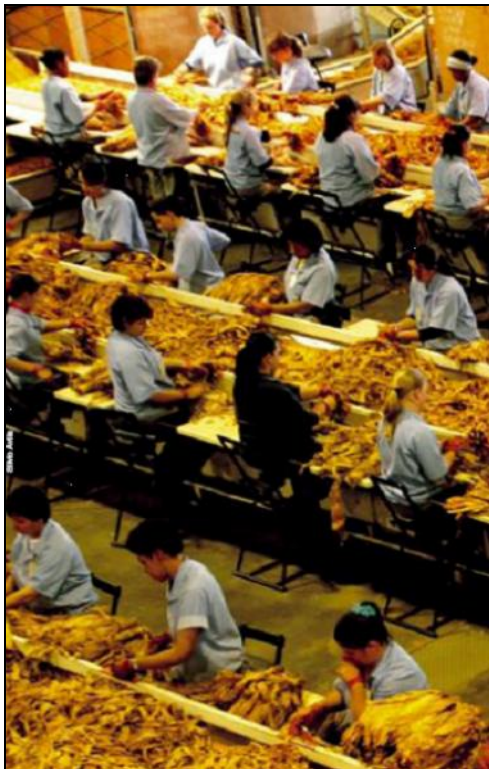
FIGURA 10: Processo de destala na indústria fumageira.
