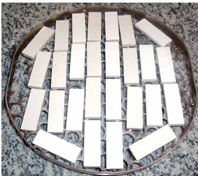
Figura 13: Tela vazada com amostras antes da autoclavagem.
