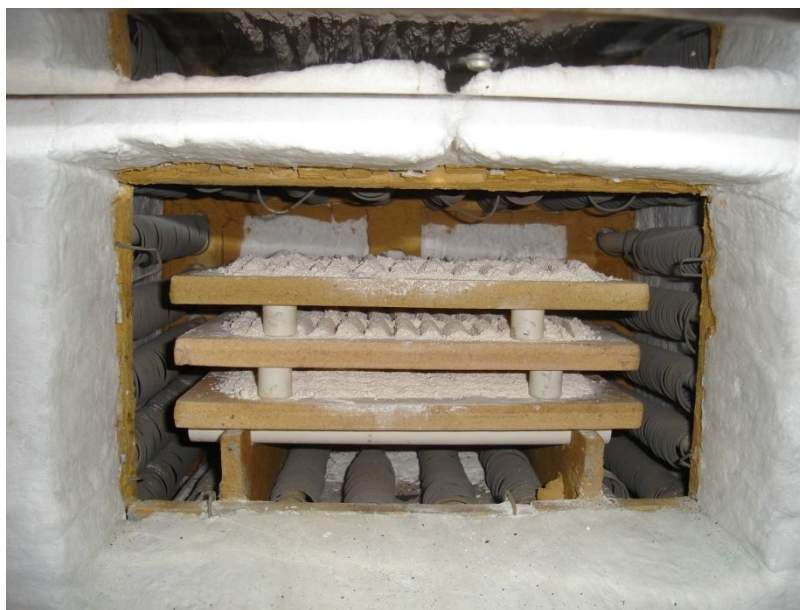
Figura 12: Disposição das placas para calcinação.
