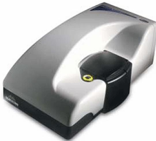
Figura 3.7 - Equipamento de medida do tamanho de partícula. Malvern Instruments, Zeta Sizer Nano S.
