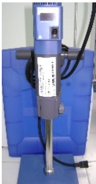
Figura 3.2 - Homogeneizador tipo rotor estator modelo IKA T25 digital ULTRA TURRAX.
