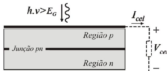
*Figura 2-4: Célula fotovoltaica do ponto de vista físico.*
