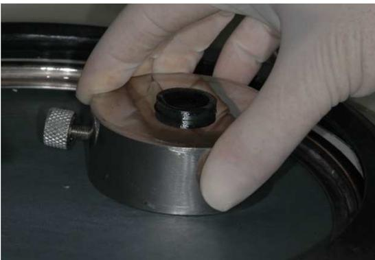
Figura 8: Superfície dental sendo desgastada em politriz, sob refrigeração, utilizando-se lixas de carbeto de silíci
