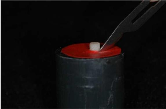
Figura 15: Remoção dos excessos de cimento, finalizando a confecção dos corpos-de-prova.
