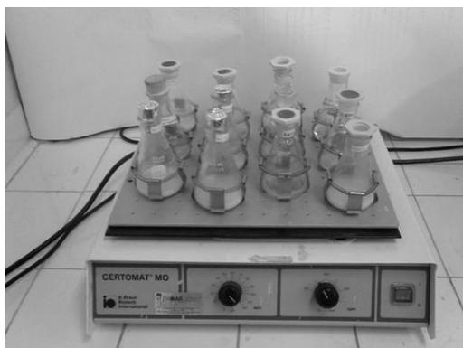
**Figura 45** – Banho orbital usado nas reações de epoxidação químio-enzimática.
