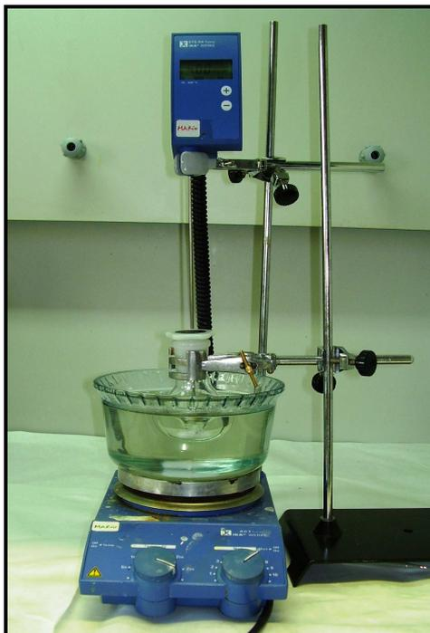
Figura 4.2 - Aparato para a síntese dos sóis
