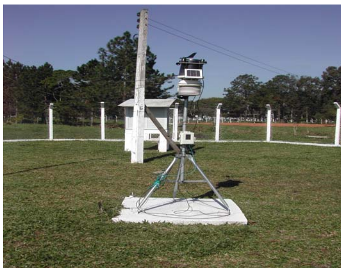
Figura 03: Estação Meteorológica Automática
