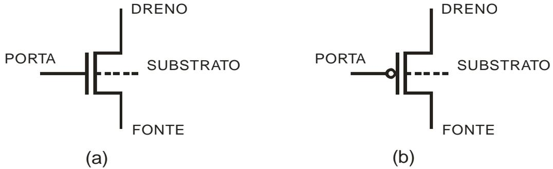
Figura 2.2 – Simbologias dos transistores. (a) NMOS e (b) PMOS
