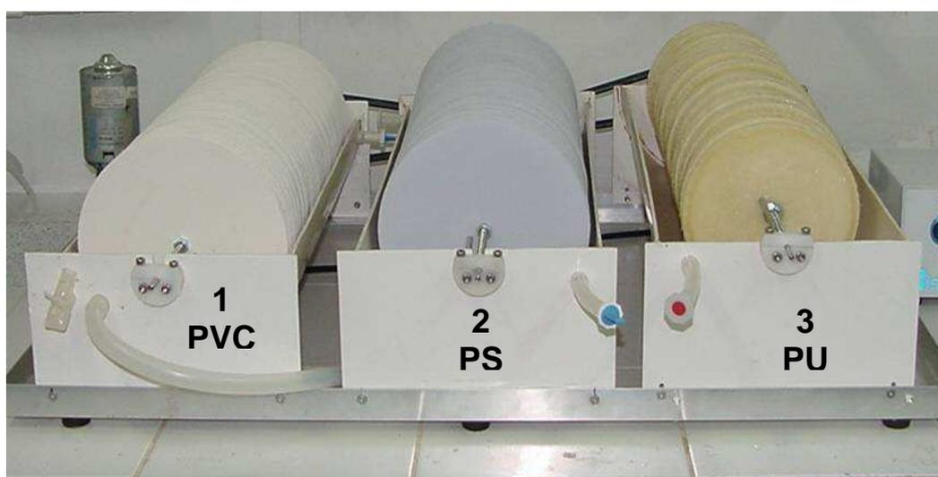
**Figura 4.2:** Sistema de reatores de biodiscos rotativos construídos em PVC, PS e PU.
