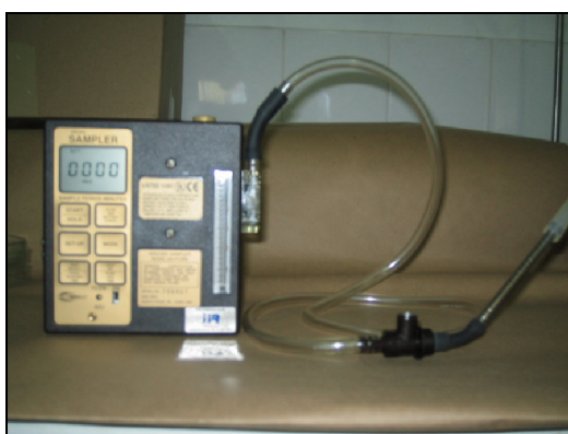
Figura 4.5: Bomba e cartucho adsorvente para amostragem de VOC nos gases de exaustão.
