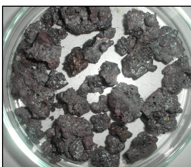
Figura 5.2: Resíduos da queima da mistura de cavaco e lodo.
