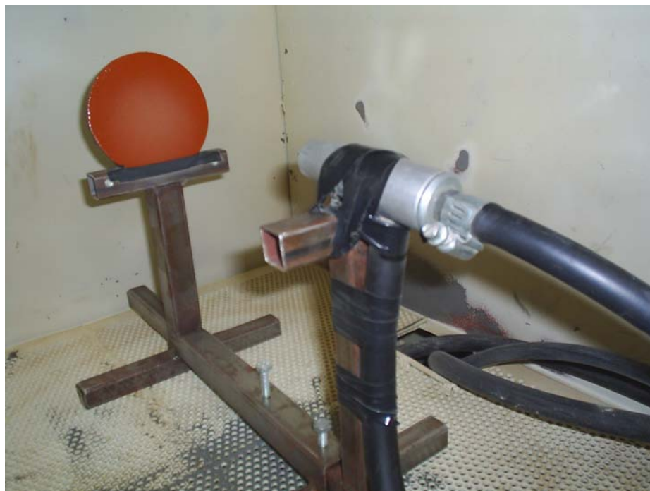
Figura 14 – Dispositivo projetado e construído para os ensaios de erosão por jateamento, com o corpo de prova na posição para o ensaio.
