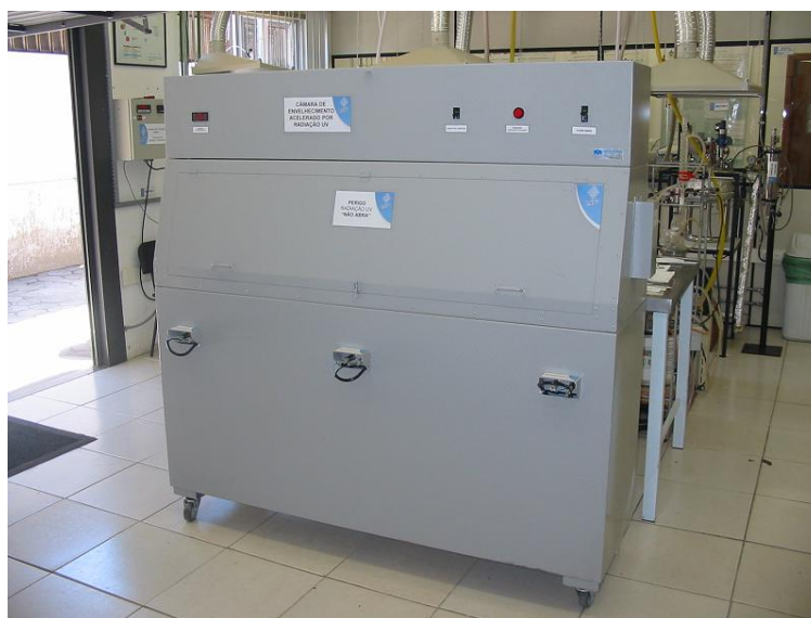
Figura 12 – Câmara de envelhecimento acelerado por radiação UV.
