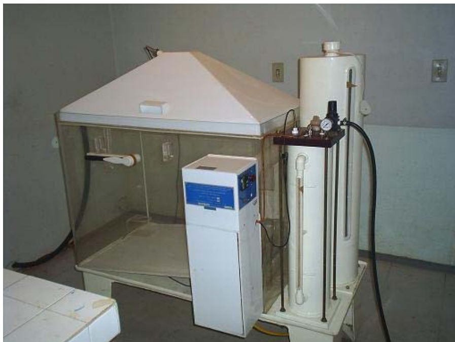
Figura 13 - Câmara para ensaio de exposição à névoa salina.
